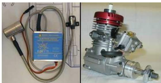
Fig. 5. Foto de los motores del sistema propulsor de UrAn
