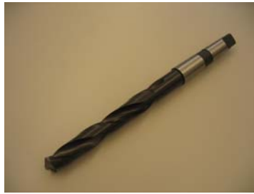
HSS Stahl (Legierungselemente Wolfram, Molybdän, Vanadium, Kobalt, Nickel und Titan). a) beschichtet mit Titannitrid, reibungsmindernd.
