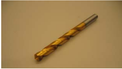
HSS Stahl (Legierungselemente Wolfram, Molybdän, Vanadium, Kobalt, Nickel und Titan). a) beschichtet mit Titannitrid, reibungsmindernd.
