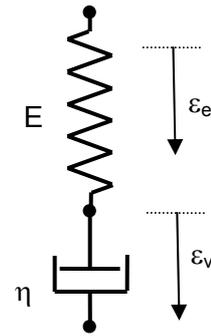
Da die Deformationen von der Zeit und den Spannungen linear abhängen, darf die Gesamtdehnung als Summe der Dehnungen, welche die einzelnen Spannungsanteile jeweils allein bewirken würden, berechnet werden. Die Dauer wird vom Flankenanstieg bis zu der Zeit, zu welcher man die Dehnungen kennen will, hier  $t_3$ , gemessen:
