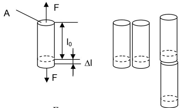
Das sind lineare Zusammenhänge: Doppelt so grosse Fläche bei gleicher Spannung heisst doppelt so grosse Kraft (z.B. zwei Stäbe parallel). Doppelt so grosse Länge bei gleicher Spannung heisst gleiche Dehnung, aber doppelt so grosse Verlängerung (zum Beispiel zwei Stäbe in Serie).
