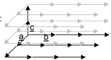
Die Beträge a, b, c sind die Gitterkonstanten, wie auch die Zwischenwinkel  $\alpha$  (zwischen  $\underline{b}$  und  $\underline{c}$ ),  $\beta$ ,  $\gamma$ . u, v, w sind die Koordinaten des Punktes P.
