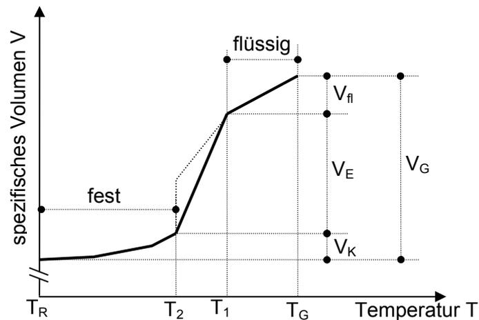
Verursacht durch diese Schwindungen können am fertigen Teil Materialdefizite auftreten in Form von Aussenlunkern, Innenlunkern (inkl. Mikrolunkern) und Einfallstellen und wegen der kubischen Schwindung. Um letztere zu kompensieren, muss das Modell und die damit hergestellte Gussform mit einem Aufmass hergestellt werden.
