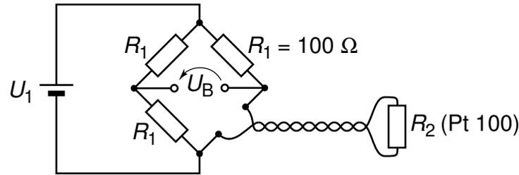
Zur Messung der Temperatur wird ein Platin-Widerstandsfühler Pt100 verwendet ( $R_2 = 100 \Omega$  bei  $0^\circ\text{C}$ , Temperaturkoeffizient  $0.4 \Omega/\text{K}$ ). Anstelle einer direkten Widerstandsmessung wird häufig eine Brückenschaltung (siehe Figur) verwendet. Die Brücke wird mit einer Gleichspannung  $U_1$  betrieben. Dabei soll die Leistung in  $R_2$  bei  $0^\circ\text{C}$   $10^{-4}$  Watt nicht übersteigen, um Fehler durch die Erwärmung des Messfühlers zu vermeiden.
