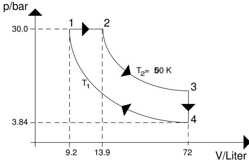
Die Maschine arbeitet mit  $\nu = 10$  mol eines idealen zweiatomigen Gases.
