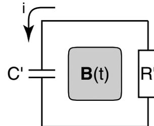
Nach der Maxwell-Gleichung gilt  $u = \oint_{\partial A} \vec{E} d\vec{s} = - \int_A \dot{\vec{B}} d\vec{A} = -\dot{\Phi}$ . Somit beträgt die induzierte Spannung  $u$  in der vorliegenden Situation, bei der  $A$  konstant ist,
