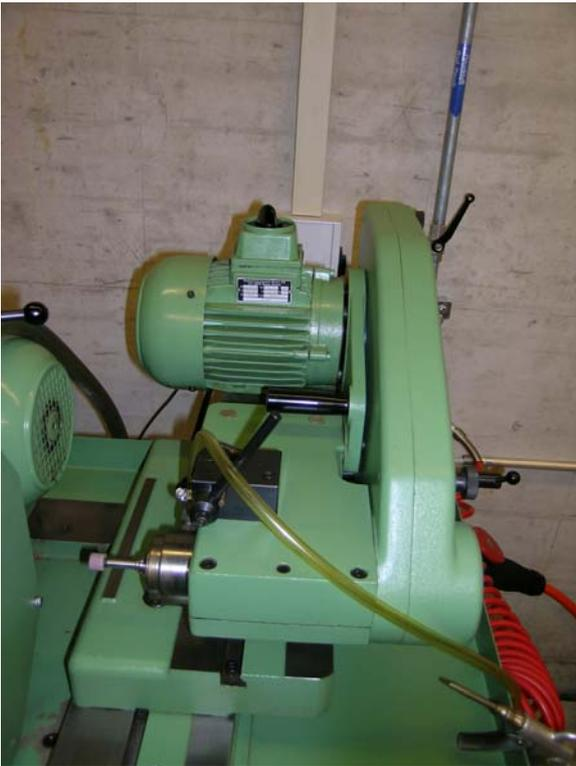
**Bild 21: Antrieb über den Riementrieb für eine Schleifmaschine**
