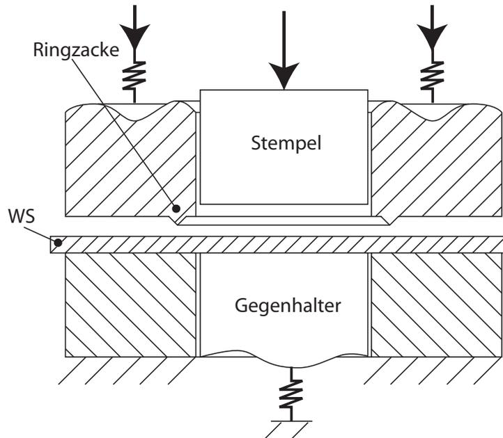
Abbildung 3: Werkzeugaufbau beim Feinschneiden
