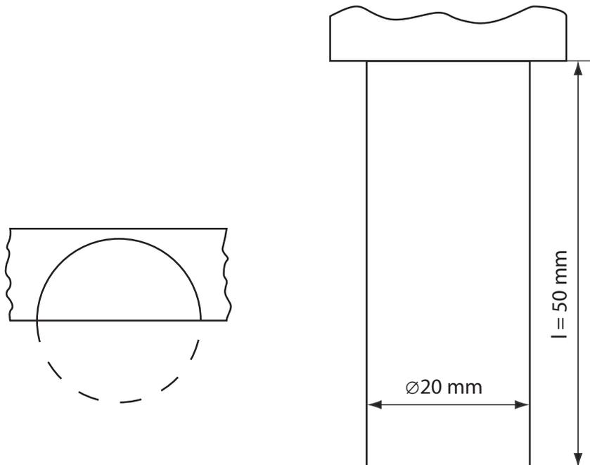
Abbildung 1: Stanzteilgeometrie für offenen Schnitt
