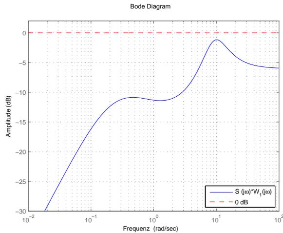
Abbildung 4: Amplitudengang  $S(s) \cdot W_1^{-1}(s)$  und 0dB (---)
