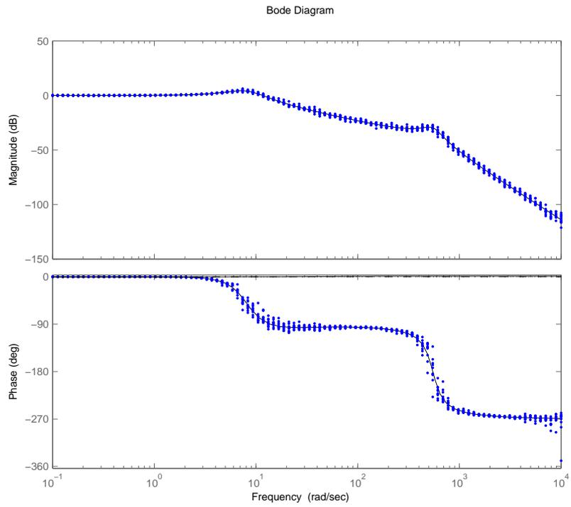
Abbildung 1: Bode Diagramm des nominalen Systems (—) und der Messreihen (●)
