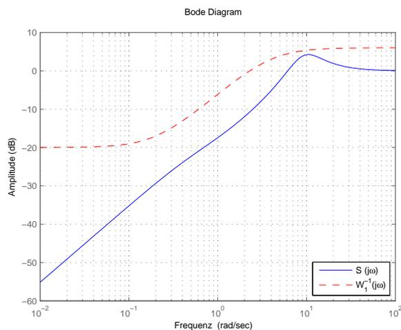
Abbildung 5: Amplitudengang der Sensitivität und der Schranke  $W_1^{-1}(s)$
