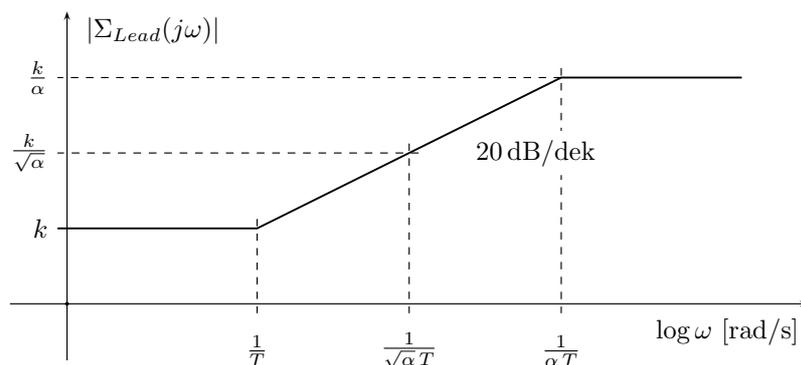
Um dem steilen Anstieg der Unsicherheit bei ca. 4 rad/s gerecht zu werden, werden zwei identische Lead-Elemente in Serie geschaltet.
