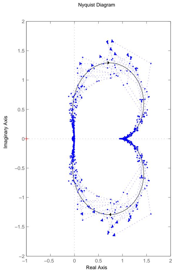
Abbildung 2: Nyquist Diagramm des nominalen Systems (—) und der Messreihen (●)
