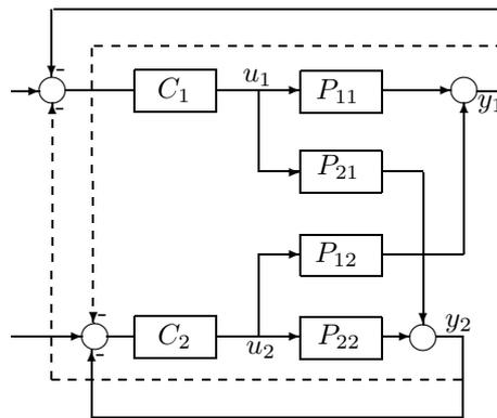
Abbildung 3: MIMO System mit guter (-) und schlechter (--) Paarung.
