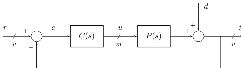
Für den “loop breaking point” bei  $e$  lauten die entsprechenden Systemgleichungen<sup>1</sup>,
