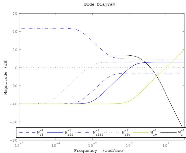
Abbildung 1: Amplitudengang der inversen Gewichtungen
