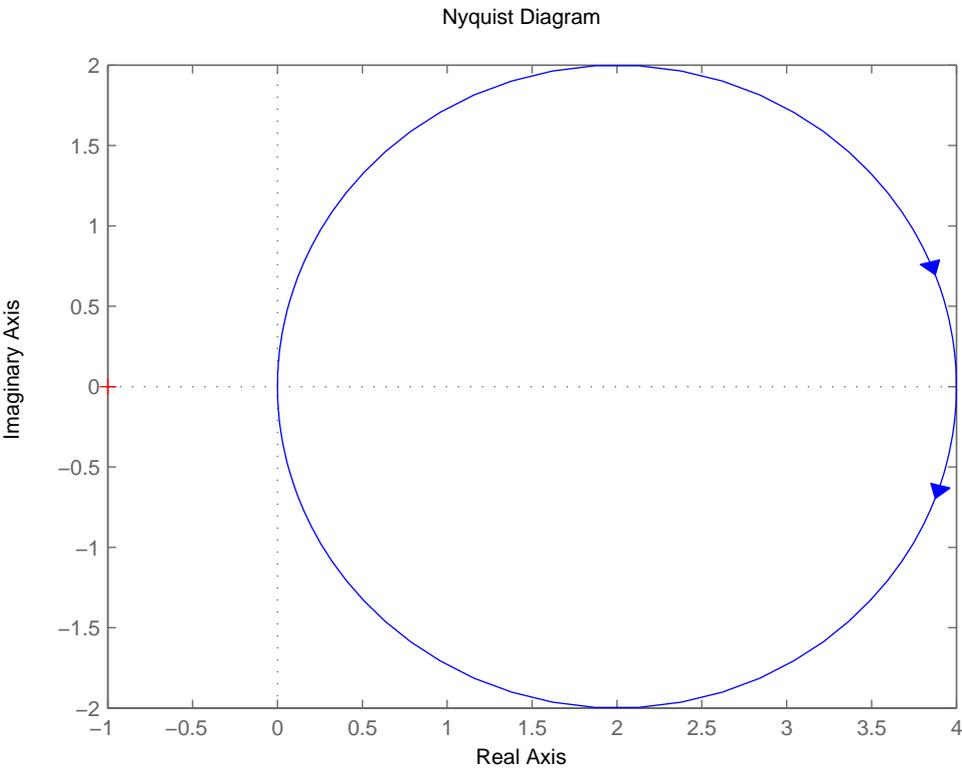
Abbildung 6: Nyquist-Kurve der Kreisverstärkung des LQ-Regulators
