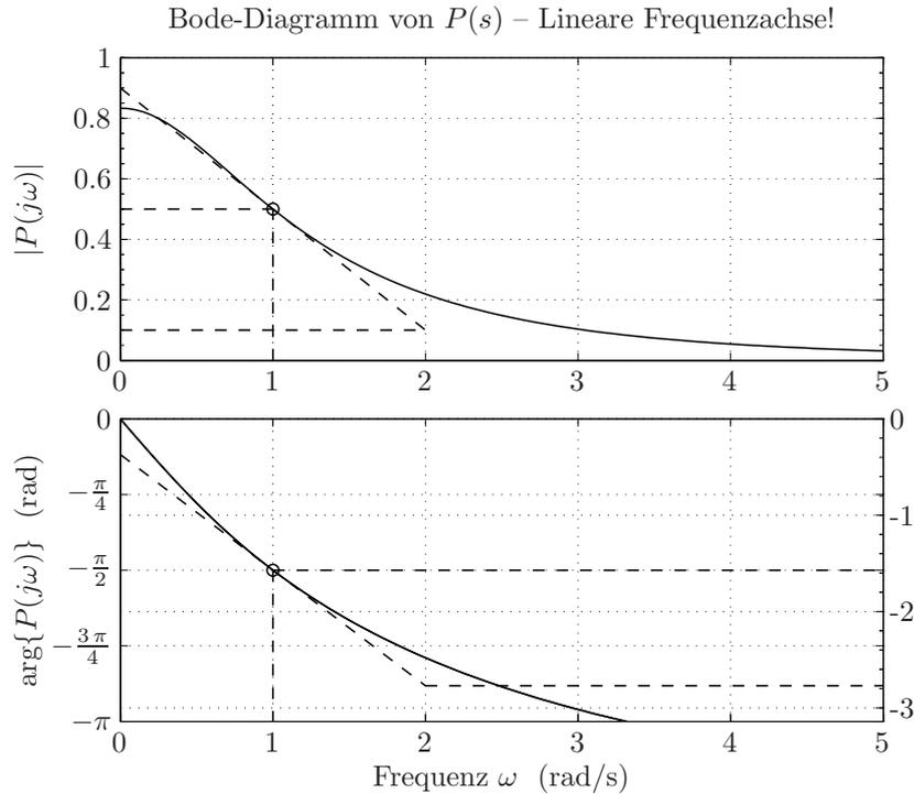
Abbildung 3: Bestimmung der charakteristischen Größen der Strecke aus dem Bode-Diagramm
