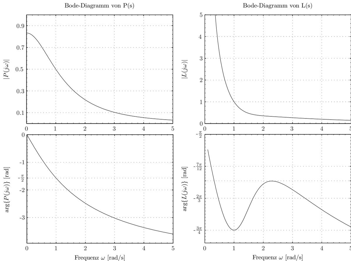
Abbildung 1: Bode-Diagramme mit linear skaliertem Frequenzachse.
