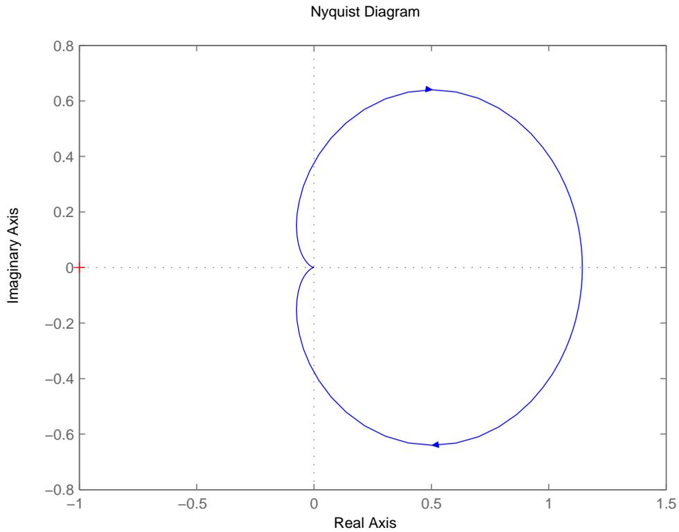
Abbildung 7: Nyquist-Kurve der Kreisverstärkung des gesamten Regelsystems
