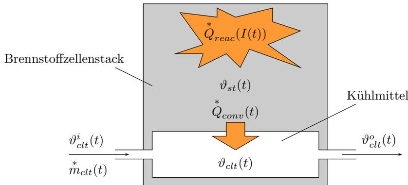
In dieser Aufgabe soll für einen wassergekühlten Brennstoffzellenstack<sup>1</sup> ein thermisches Modell erstellt und analysiert werden. Dazu werden die folgenden vereinfachenden Annahmen gemacht:
