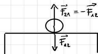
Eine Kugel wirkt auf den Tisch eine Kraft  $\vec{F}_{12}$  aus. Diese Kraft ist gleich gross wie die Kraft die der Tisch auf die Kugel auswirkt. Wäre dies nicht der Fall, würde die Kugel durch den Tisch hindurchfliegen.
