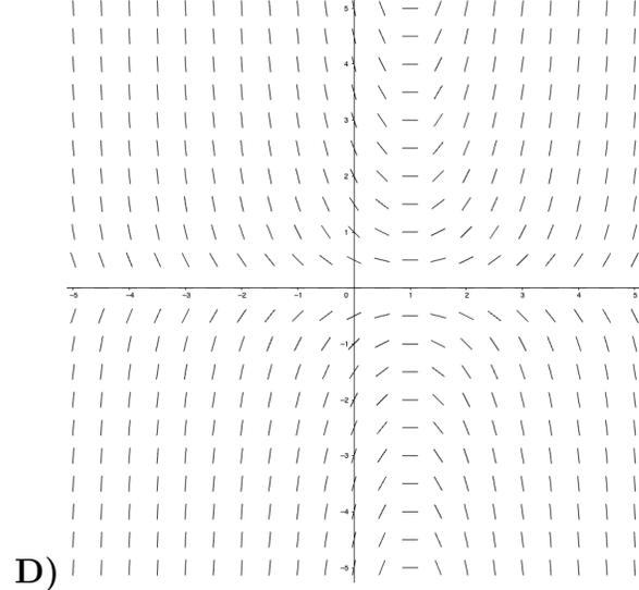
**Solution:** Eine stationären Lösung der Differentialgleichung ist  $y(x) = 3$ . Da stationäre Lösungen waagerechte Linien im Richtungsfeld sind, können wir B) und D) ausschliessen. Ausserdem haben wir Nullstellen bei  $x = \pm 1$ , da für  $x^2 - 1 = 0$  auch  $y'(x) = 0$  gilt. Somit können wir A) aufgrund der fehlenden stationären Lösung  $x = 1$  ausschliessen. Die richtige Antwort ist also C).
