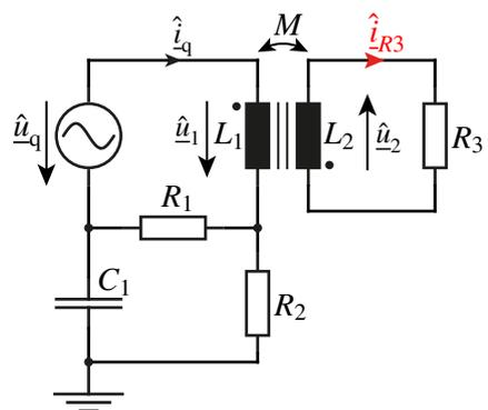
Abbildung 2: Schaltung mit Spannungsquelle  $\hat{u}_q$  und einem Transformator.
