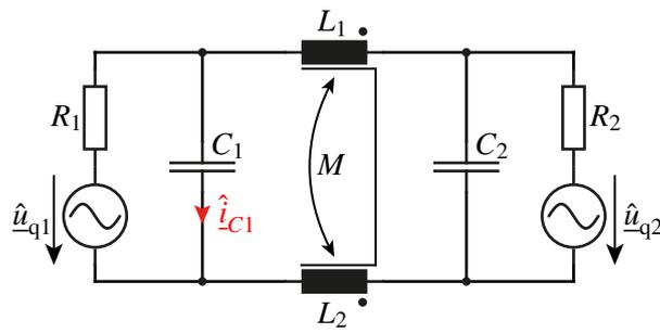
Abbildung 2: Schaltung mit Transformator sowie den Spannungsquellen  $\hat{u}_{q1}$  und  $\hat{u}_{q2}$ .
