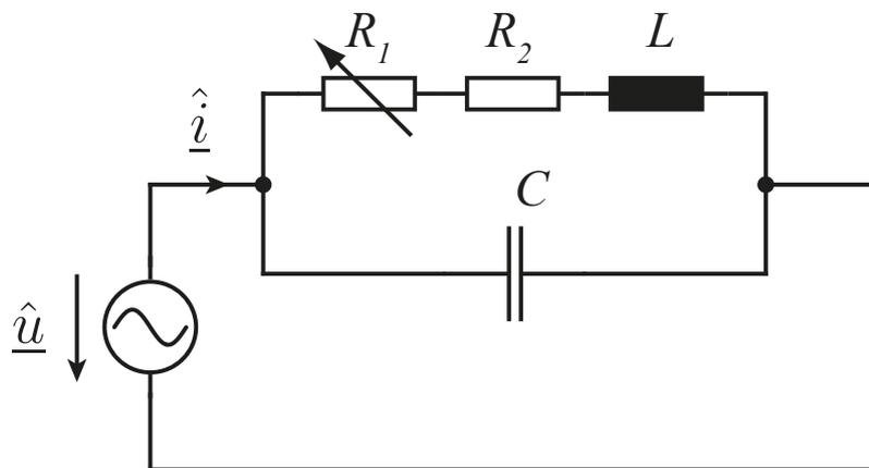
Abbildung 2: Parallelschwingkreis mit Potentiometer  $R_1$
