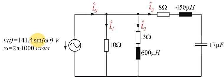
Abbildung 1: Wechselstromnetzwerk I
