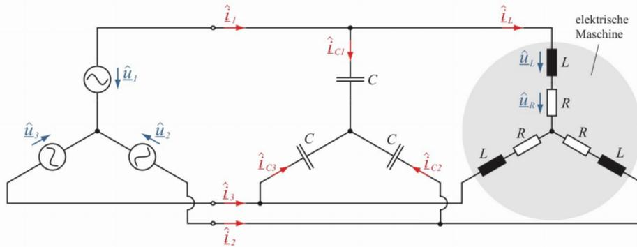
a.) Berechnen Sie den Strom  $\hat{i}_L$  und die Spannungen  $\hat{u}_R$  und  $\hat{u}_L$ .
