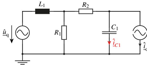
Abbildung 1: Schaltung mit Spannungsquelle  $\hat{u}_q$  und Stromquelle  $\hat{i}_q$ .
