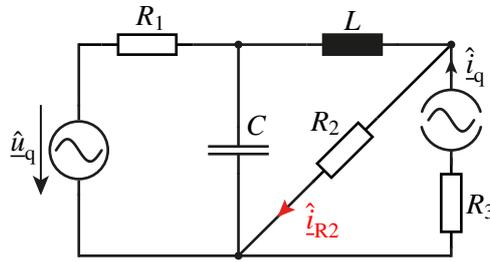
Abbildung 1: Schaltung mit einer Spannungsquelle  $\hat{u}_q$  und einer Stromquelle  $\hat{i}_q$ .
