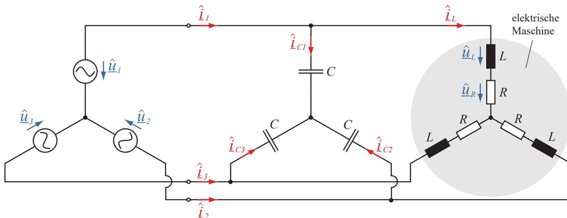
Abbildung 1: Dreiphasenspannungsquelle und Ersatzschaltbild der elektrischen Maschine mit Kondensatoren zur Blindleistungskompensation.
