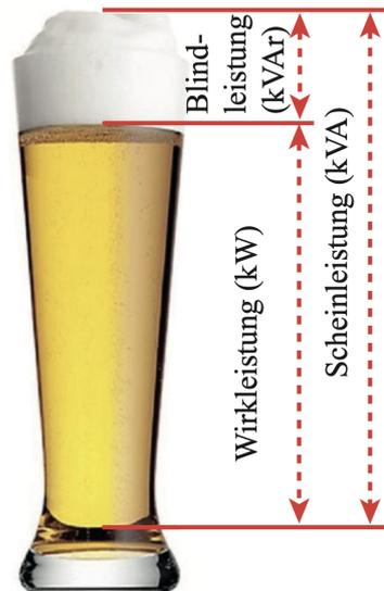
Figure 2: Scheinleistung  $S$  in [VA] (Bier + Schaum), Blindleistung  $Q$  in [VAR] (Schaum) und Wirkleistung  $P$  in [W] (Bier).
