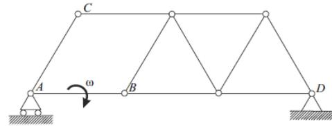
In welche Richtung rotiert der Stab  $AC$ ? Wie gross ist seine Winkelschnelligkeit?
