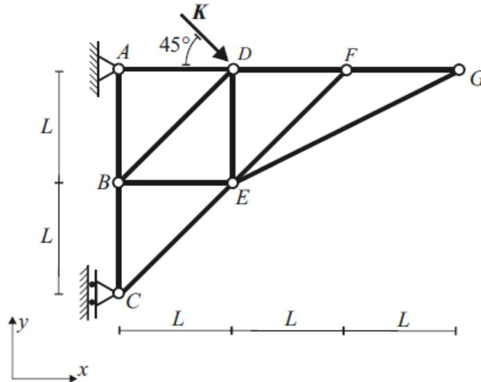
Berechnen Sie die Stabkraft in Stab  $DE$  mit dem PdvL. Verwenden Sie dazu die unten angegebene Zeichnung und den vorgegebenen zulässigen virtuellen Bewegungszustand.
