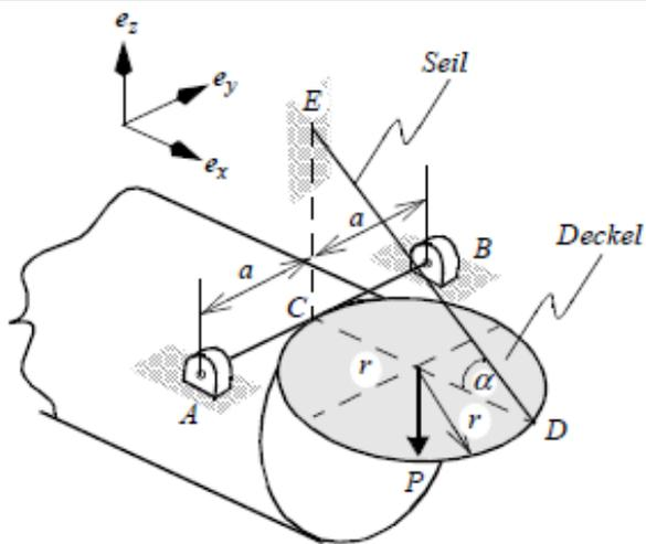
Deckel ist in C mit Stab AB verschweisst
