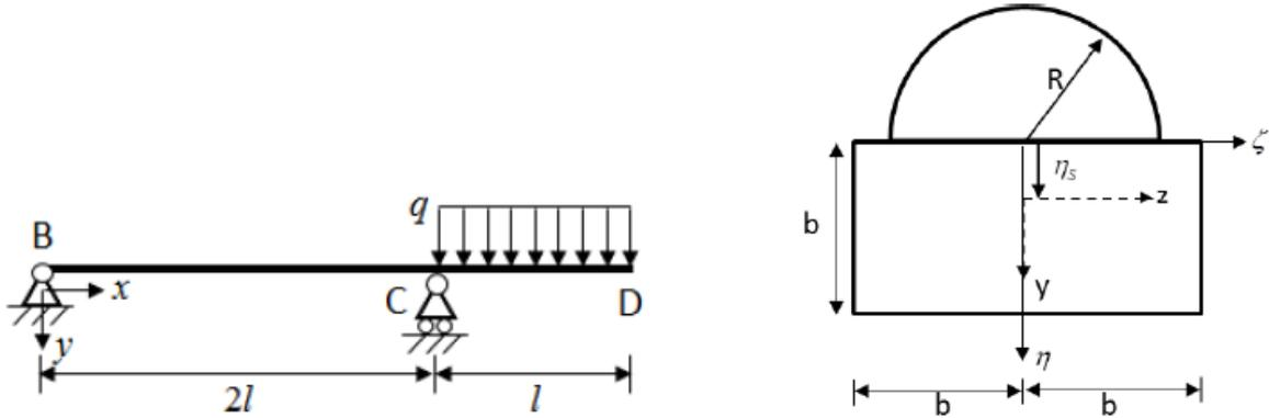
Der monolithische Querschnitt besteht aus einem rechteckigen und einem halbrunden Teil. Im dargestellten  $\eta - \zeta$  -Koordinatensystem liegt der Punkt  $\eta = 0$  auf der Übergangslinie zwischen den rechteckigen und halbrunden Teilen des Querschnitts. Der Ursprung des  $y - z$  -Koordinatensystems liegt im Schwerpunkt mit den Koordinaten  $\eta_s = \eta_s(R, b)$  und  $\zeta_s = 0$ .
