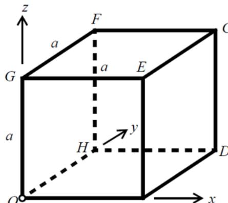
Ein Würfel (Abbildung 1) hat im Punkt  $H$  die Kinemate  $\underline{v}_H = \begin{pmatrix} 0 \\ v \\ 2v \end{pmatrix}$ ,  $\underline{\omega} = \begin{pmatrix} v/a \\ v/a \\ -v/a \end{pmatrix}$
