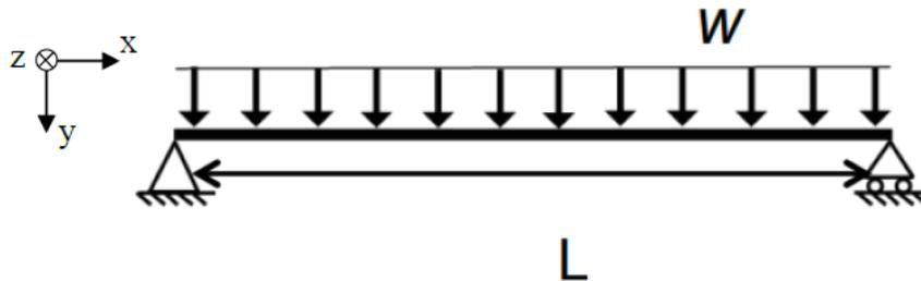
a) Berechnen Sie zuerst den Beanspruchungsverlauf der Querkraft  $Q(x)$
