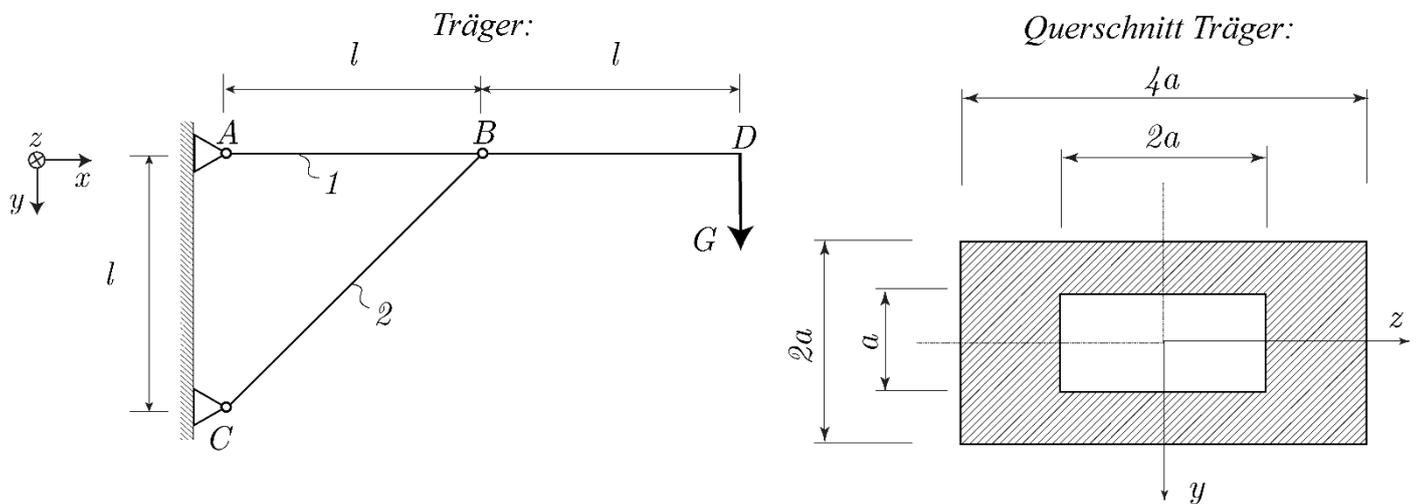
Das abgebildete System besteht aus zwei starren Trägern, welche sowohl in  $A$  wie auch in  $C$  gelenkig gelagert und in Punkt  $B$  gelenkig verbunden sind. An Ende des Stabes 1 in Punkt  $D$  zieht eine Kraft mit Betrag  $G$  in  $y$ -Richtung nach unten. Der Querschnitt des oberen Körpers ist ebenfalls in der Skizze abgebildet. Alle bekannten Größen sind in der Skizze eingezeichnet.
