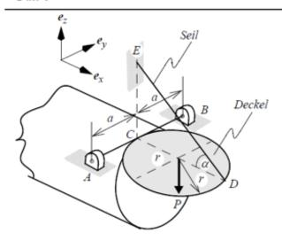
Deckel ist in C mit Stab AB verschweisst Die Kraft P zeigt in die negative z-Richtung
