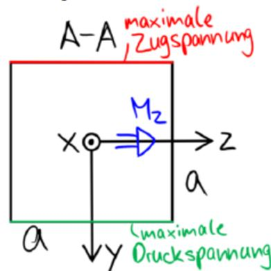
Die Biegespannung ist folgendermassen definiert:  $\sigma_b(x, y) = -\frac{M_z(x) \cdot y}{I_z}$
