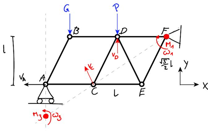
Anhand vom SdpG wissen wir, dass  $v_B$  auch Senkrecht auf Stab  $BD$  stehen muss. Mit dem S.v.M kann man weiter  $MZ_2$  bestimmen und mit der Parallellogrammregel:
