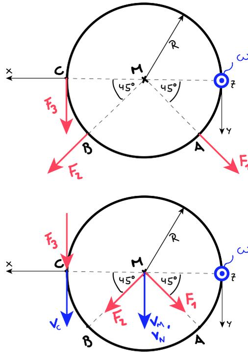
**b)** Um die Leistung  $P = \sum_i \vec{\omega} \cdot \vec{M}_i$  zu bestimmen, brauchen wir alle  $\vec{M}_i$ . Bemerke die Invariante  $\vec{\omega}$  ist konstant im ganzen Körper. Wir berechnen die Momente  $\vec{M}_O(F_i)$  bzgl. Punkt O da hier unsere Geschwindigkeit  $\vec{v}_O = \vec{0}$ :
