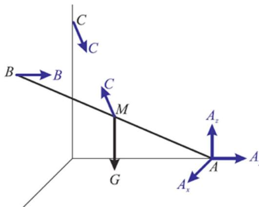
$$A = \begin{bmatrix} A_x \\ A_y \\ A_z \end{bmatrix}; B = B \begin{bmatrix} 0 \\ 1 \\ 0 \end{bmatrix}; C = \frac{C}{\sqrt{3}} \begin{bmatrix} -1 \\ -1 \\ 1 \end{bmatrix};$$
