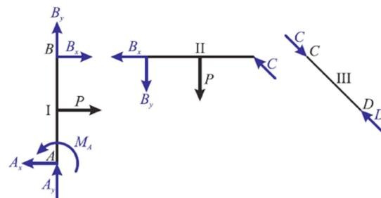
b) Da die Kraft  $B_x$  negativ ist, wirkt sie eigentlich in die andere Richtung (mit der x-Achse). Der Stab  $BC$  wird also auf Druck belastet.
