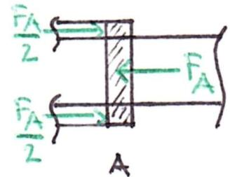
**Bolzen in B und D (auf Scherung beansprucht):**
