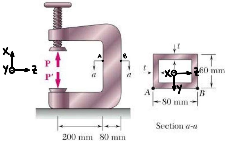
Wir führen eine Beanspruchung im gesuchten Querschnitt  $a-a$  ein. Wichtig: Die Normalkraft  $N$  zeigt hier in die gleiche Richtung wie  $x$ , also ist das ein positives Schnittufer und deshalb zeigen die Reaktionskräfte  $(Q, M_y)$  in die positive Richtung:
