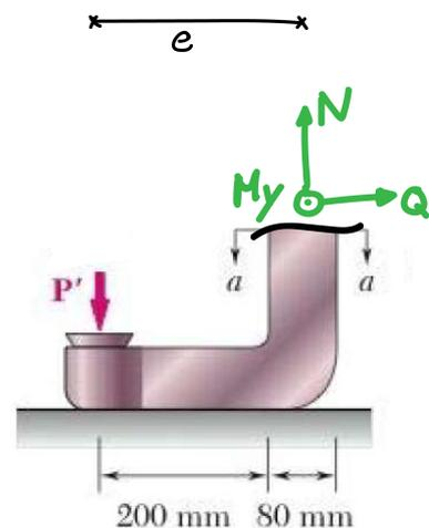
Um nachher die Biegespannungen zu berechnen, müssen wir zuerst das FTM in  $y$ -Richtung bestimmen, weil ein Moment in  $y$ -Richtung auftritt:
