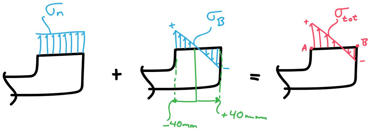
Bevor wir die Biegespannung mit  $\sigma_B = \frac{M_y \cdot (z)}{I_y}$  berechnen müssen wir in diesem Bauteil noch die Normalspannung  $\sigma_N = \frac{N}{A}$  berücksichtigen. Bei Spannungen gilt auch wieder das Superpositionsprinzip:
