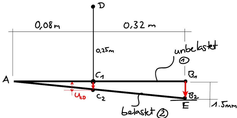
Wir benutzen den Strahlensatz, um die Verhältnisse der Verlängerungen zu berechnen. Weil  $AB \gg BE$  nehmen wir an, dass das ganze sich rein in  $y$ -Richtung verschiebt und nicht auf einer Kreisbahn:
