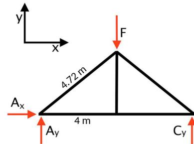
Knotengleichgewicht im Punkt  $A$  einführen, um die Stabkräfte  $AD$  und  $AB$  zu berechnen:
