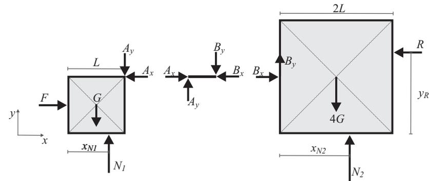
Durch das Momentengleichgewicht am Stab in A oder B kann gesehen werden, dass  $A_y = B_y = 0$  gelten muss.
