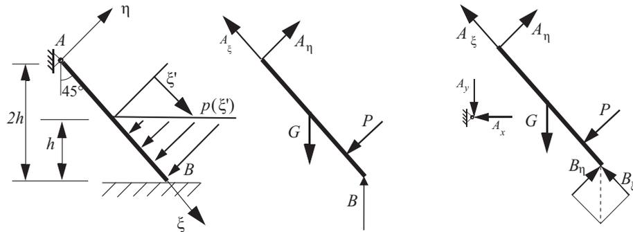
Reaktionskraft  $B$  im Punkt B wirkt senkrecht zur Oberfläche des Bodens (Auflage).
