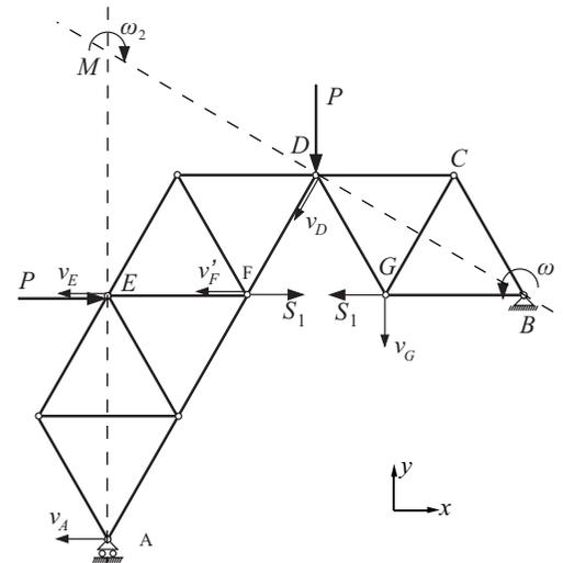
Virtuelle Geschwindigkeit oder Winkelgeschwindigkeit einführen ( $\omega$  in  $B$ ). Das System hat insgesamt zwei Körper. Körper  $BCDG$  rotiert um  $B$  mit der Winkelgeschwindigkeit  $\omega$ .
