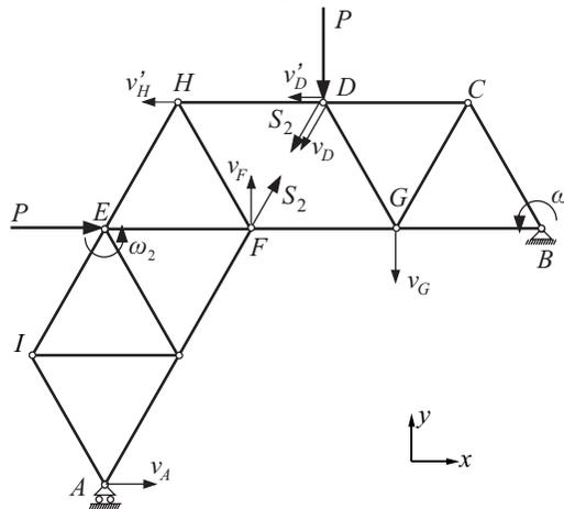
Virtuelle Geschwindigkeit oder Winkelgeschwindigkeit einführen ( $\omega$  in  $B$ ). Das System hat insgesamt vier Körper. Körper  $BCDG$  rotiert um  $B$  mit der Winkelgeschwindigkeit  $\omega$ .
