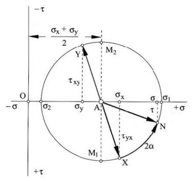
Aus dem Mohr'schen Kreis lassen sich verschiedene Formeln für eine Rotation der Bezugsachsen sowie die Maximalspannungen herleiten.
