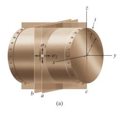
Druckbehälter stehen häufig unter hohen Normalspannungen. Diese hängen ab vom Innendruck p.
