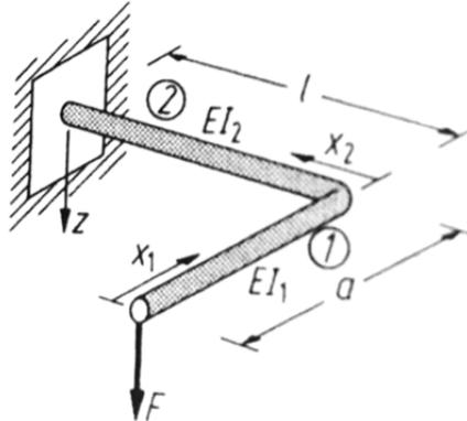
Wie groß ist die Absenkung  $f$  des Kraftangriffspunktes unter Vernachlässigung der Schubdeformationen aufgrund der Querkraft, wenn das Flächenträgheitsmoment für Torsion im Abschnitt 2  $I_T$  ist?
