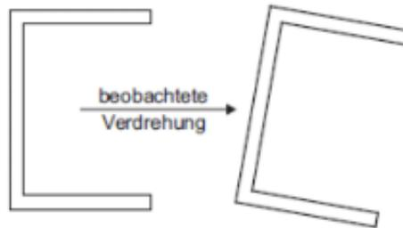
Die Begründung dieser Art der Deformation lässt sich mittels der Betrachtung der Schubspannungsverteilung erklären.
