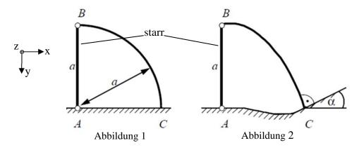
Man ermittle die in A und C auftretende Reaktionen mittels Arbeitsgleichung.
