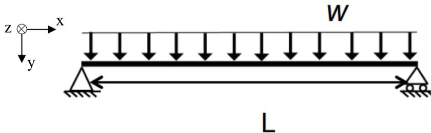
a) Berechnen Sie zuerst den Beanspruchungsverlauf der Querkraft  $Q(x)$
