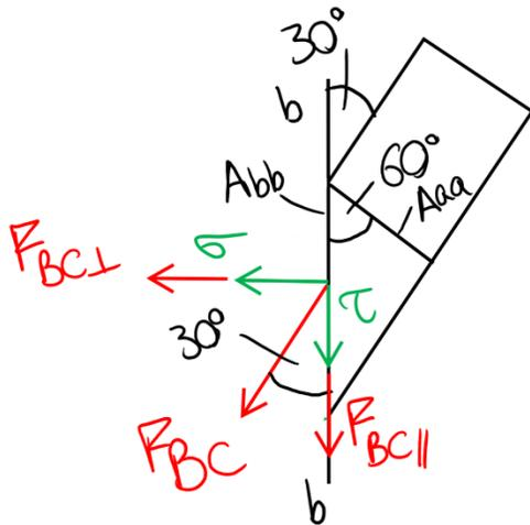
Wenn man die Skizze betrachtet ist es in diesem Fall klar, dass die Stabkraft auf diesem Querschnitt eine Normal- und eine Schubspannung erzeugt.
