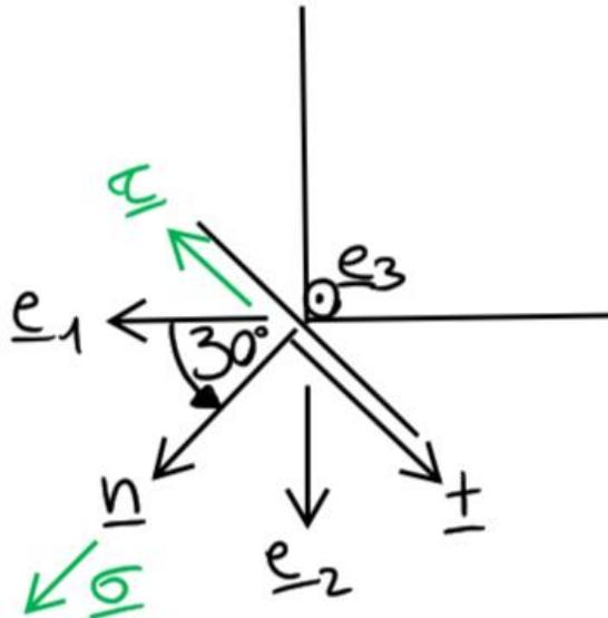
Bemerkung: Die Richtung von  $\underline{t}$  lässt sich aus der Tatsache bestimmen, dass die Vektoren  $\underline{\sigma}$ ,  $\underline{t}$  und  $\underline{e}_3$  eine Orthonormalbasis bilden müssen.
