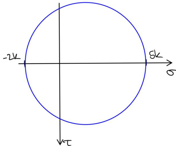
Bemerkung: Da  $\sigma_1$  und  $\sigma_2$  Hauptachsen sind, wissen wir, dass sie auf der Spannungsachse liegen, da in einem Hauptspannungszustand die Schubspannungen verschwinden. Deshalb können wir einfach die Werte auf der Spannungsachse eintragen und den Kreis zeichnen.
