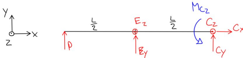
1.2 Mittels GGB die Kräfte in C und E berechnen
