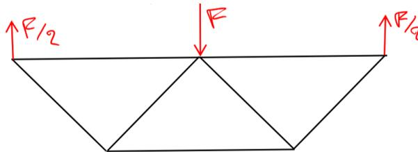
Bemerkung: Aus Symmetriegründen sieht man sofort, dass die zwei Lagerkräfte  $\frac{F}{2}$  betragen müssen, weil sie von der Kraft  $F$  gleich weit entfernt sind.
