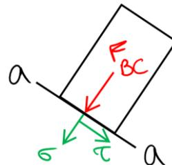
Da die Stabkraft senkrecht zur Querschnittsfläche a-a steht, wird es keine Kraftkomponenten haben, die parallel zur Bezugsfläche sind. Daraus folgt, dass die Schubspannung auf diesem Querschnitt gleich Null ist.
