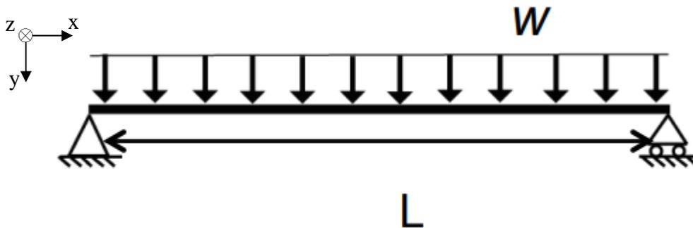
Der Biegemoment  $M_b(x)$  sei  $M_b(x) = \frac{1}{2}wx(x - L)$ . Berechnen Sie die Biegelinie  $v(x)$ .
