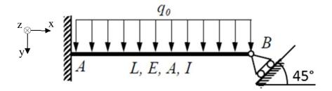
Berechnen Sie die Verschiebungen in B.
