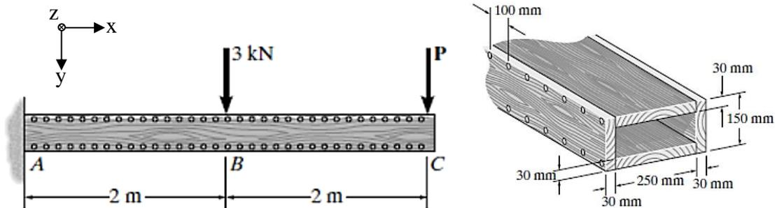
Da der Balken als Stütze dienen sollte, ist man an der maximalen Kraft  $P$  interessiert, die die Nägel aushalten würden. Berechnen Sie diese.
