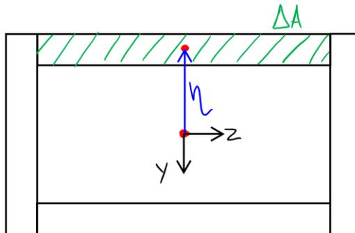
$$H_z = \eta \cdot \Delta A = 60\text{mm} \cdot 30\text{mm} \cdot 250\text{mm} = 45 \cdot 10^4 \text{mm}^3$$
