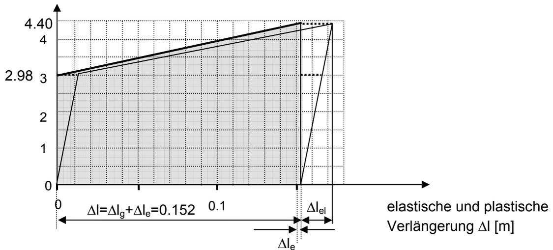
Die durch plastische Verformung bis zum Bruch aufgenommene Arbeit  $E_B$  ist Kraft mal Weg, im Diagramm also die graue Fläche:
