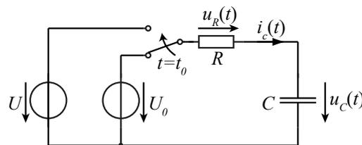
Abbildung 1: Netzwerk mit ohmsch-kapazitiver Last
