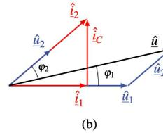
Figure 1.19: a) Beispielnetzwerk für die Konstruktion eines Zeigerdiagramms. b) Resultierendes Zeigerdiagramm.
