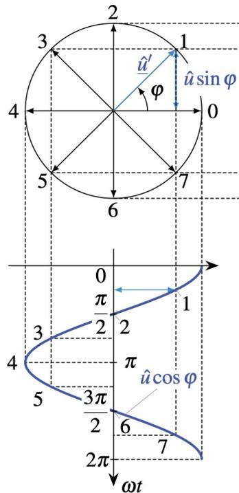
Da wir in der komplexen Wechselstromrechnung nur Netzwerke analysieren, bei welchen alle Signale dieselbe Frequenz haben, führen alle Zeiger die gleiche Rotation  $e^{j\omega t}$  um den Ursprung:
