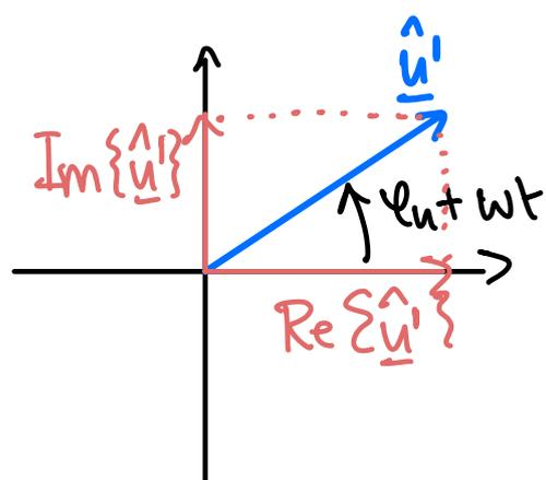
$$\underline{\hat{u}}' = \hat{u} e^{j\varphi_u} e^{j\omega t} = \underbrace{\hat{u} \cos(\omega t + \varphi_u)}_{\text{ursprüngliches Signal}} + \underbrace{\hat{u} j \sin(\omega t + \varphi_u)}_{\text{konstruierter, imaginärer Teil}}$$
