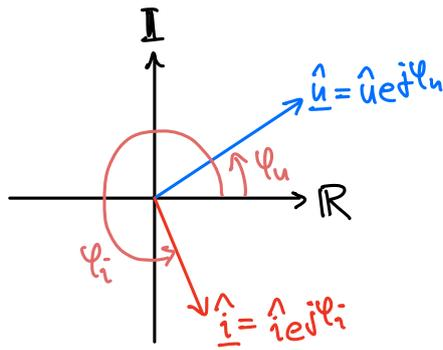
"Zeigerdiagramme" sind Diagramme von ..... eines Netzwerks in einem ..... (d.h.  $t$  fix! meistens  $t=0$ ). Man zeichnet dann alle Spannungen & Ströme (bzw. die die in einer Aufgabe gefragt sind) eines NW's in das Zeigerdiagramm ein. Dabei darf man die Zeiger wie ..... graphisch addieren / subtrahieren / multiplizieren!
