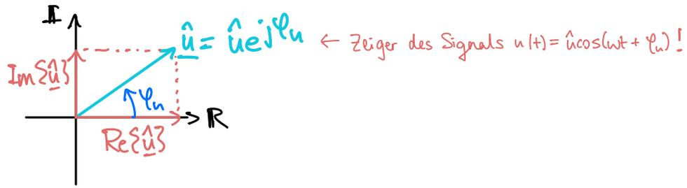
Dann analysieren wir das NW mit den zeitunabhängigen Zeiger. Erst am Schluss geben wir den Zeigern ihre zeitabhängigkeit zurück (d.h. mal  $e^{j\omega t}$  und "es fängt alles an mit der gleichen Geschwindigkeit zu rotieren").
