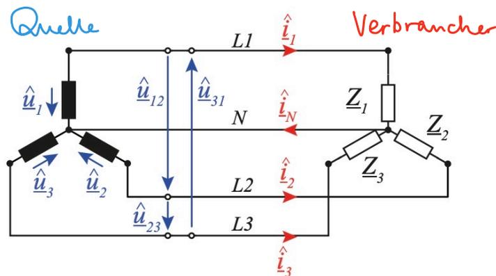
Abbildung 1: Sternschaltung mit Sternteiler
