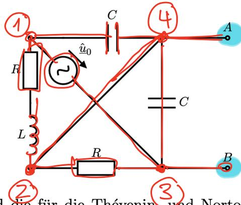
Abbildung 2: Gesucht sind die für die Thévenin- und Nortonersatzschaltung erforderlichen Kenngrößen Leerlaufspannung  $\hat{u}_{LL}$ , Kurzschlussstrom  $\hat{i}_{KS}$  und Innenimpedanz  $Z$  bezüglich den Klemmen A und B.
