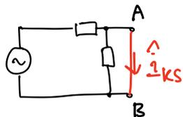
**Innerimpedanz/-admittanz  $Z_i$  resp.  $Y_i$** : Alle Quellen auf Null setzen &
