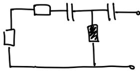
**Aktive Zweipole** sind Zweipole, die neben passiven Bauelementen auch Quellen & Transistoren enthalten.
