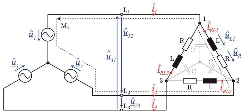
Abbildung 1: Dreiphasenspannungsquelle und Ersatzschaltbild eines elektrischen Motors mit einem Blindstromkompensationsnetzwerk.
