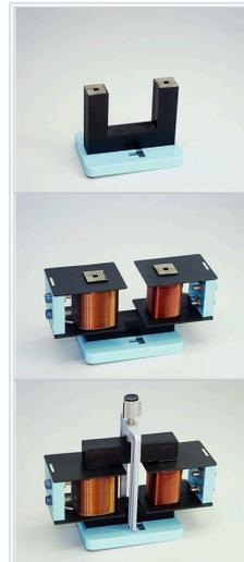
Aus Komponenten zusammensetzbarer Transformator zu Anschauungszwecken. Oben der U-förmige Teil des Eisenkerns, im mittleren Bild mit aufgesteckten Spulen; im unteren Bild mit einem weiteren ferromagnetischen (Eisen-)Joch über dem „U“-Kern, mit dem der *magnetische Kreis* durchgehend geschlossen wird.
