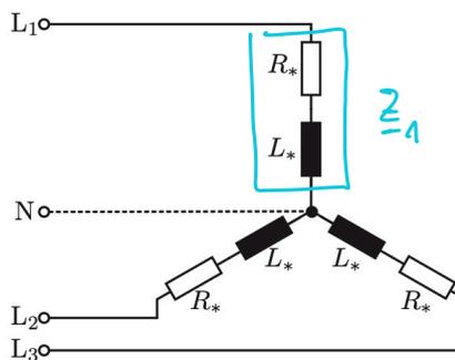
Abbildung 2: Elektrischer Motor als Sternschaltung (ohne Blindleistungskompensationsnetzwerk)
