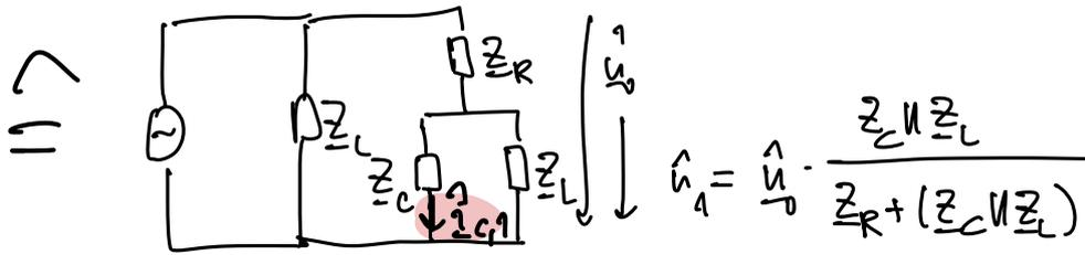
$$\hat{i}_{c1} = \frac{1}{Z_C} \cdot \frac{Z_C \parallel Z_L}{Z_R + (Z_C \parallel Z_L)} \cdot \hat{u}_0 = \frac{1}{Z_C} \cdot \frac{\frac{Z_C Z_L}{Z_C + Z_L}}{Z_R + \frac{Z_C Z_L}{Z_C + Z_L}} \cdot \hat{u}_0 \frac{Z_C + Z_L}{Z_C + Z_L}$$
