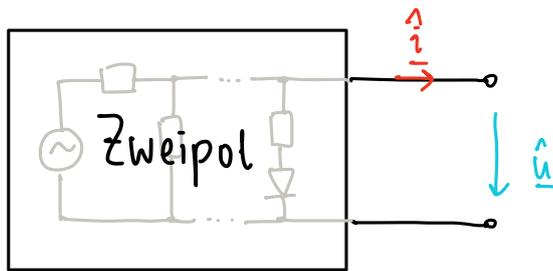
Ein Zweipol ist ein abgeschlossenes Netzwerk ohne elektrische oder magnetische Kopplung nach aussen.
