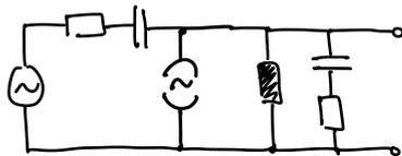
**Lineare Zweipole** sind Zweipole, deren Verhalten unabhängig von der Spannungs- & Stromamplitude ist. Sie weisen ein lineares Klemmverhalten auf.
