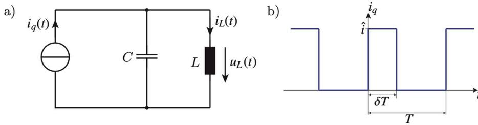
Abbildung 4: a) Gegebene Schaltung, b) Zeitverlauf von  $i_q(t)$
