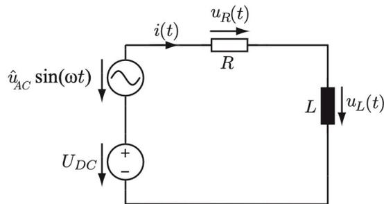
Abbildung 1: Netzwerk mit Gleich- und Wechselspannungsquelle
