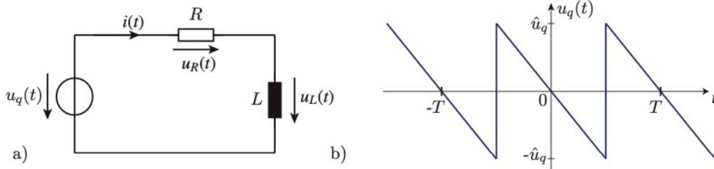
Abbildung 4: a) Gegebene Schaltung, b) Zeitverlauf von  $u_q(t)$
