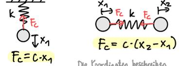
• aufpassen, wo die entspannte Lage der Feder ist: hier ist die entspannte Länge der Feder bei 0.
