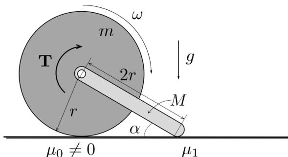
1. Wie gross muss der Gleitreibungskoeffizient  $\mu_1$  sein, damit sich das System mit einer Konstante Geschwindigkeit bewegt?
