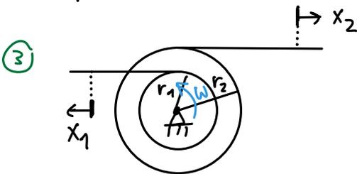
$$\omega = \frac{\dot{x}_1}{r_1} = -\frac{\dot{x}_2}{r_2} \Rightarrow \dot{x}_2 = -\frac{r_2}{r_1} \dot{x}_1$$
