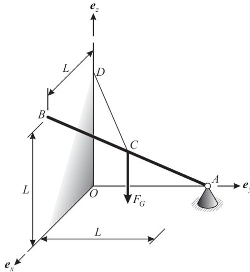
Berechnen Sie die Bindungskräfte in den Punkten  $A$ ,  $B$  und  $C$ .
